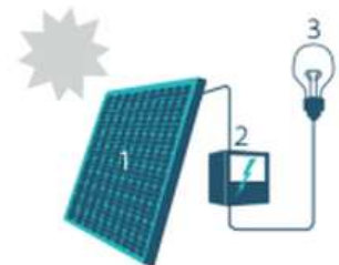
1. Zonnepaneel | 2. Omvormer | 3. Elektrische toestellen
