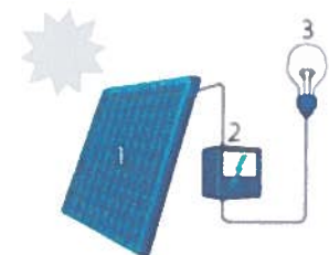
1. Zonnepaneel | 2. Omvormer 3. Elektrische toestellen
