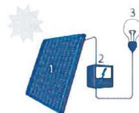
1. Zonnepaneel | 2. Omvormer | 3. Elektrische toestellen
